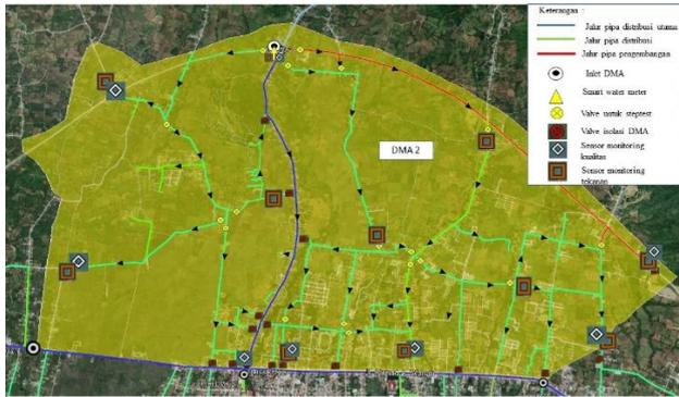
Gambar 5. Perencanaan peletakan sensor pada DMA 2
