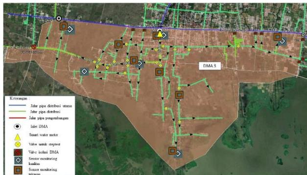
Gambar 6. Perencanaan peletakan sensor pada DMA 3
