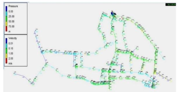
**Gambar 3.** Simulasi Epanet DMA1, DMA2, dan DMA3
