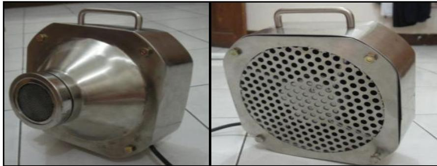
**Gambar 2.** *Casing* HVAS-A1 bagian depan (kiri) dan bagian belakang (kanan)
