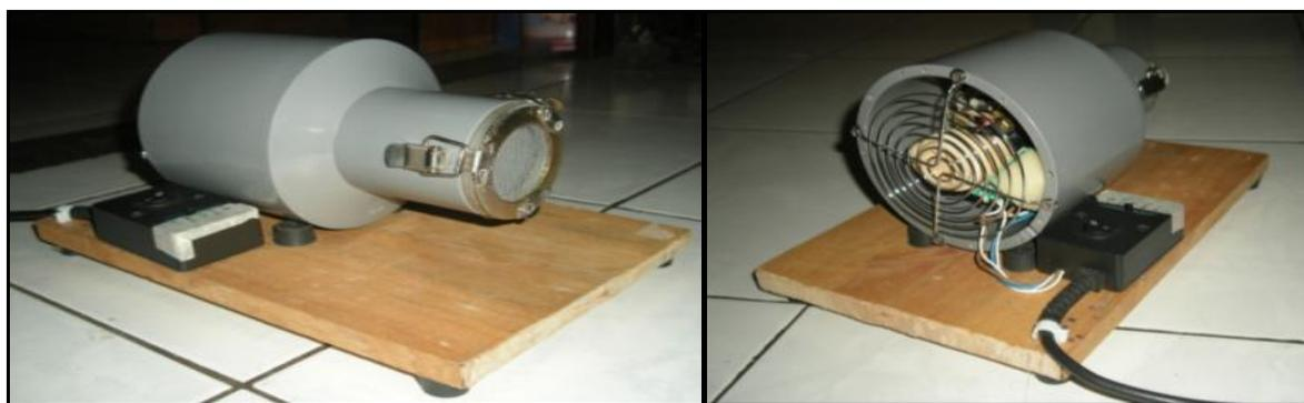
**Gambar 3.** *Casing* HVAS-V1 bagian depan (kiri) dan bagian belakang (kanan)
