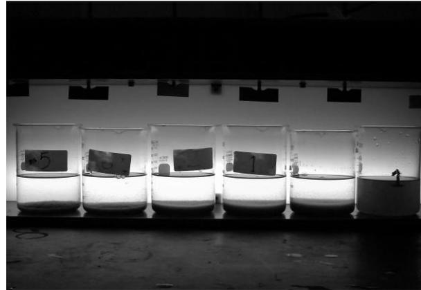
**Gambar 1.** Hasil Percobaan Pemisahan Mikroalga Dengan Metode Koagulan/Flokulasi Skala Laboratorium
