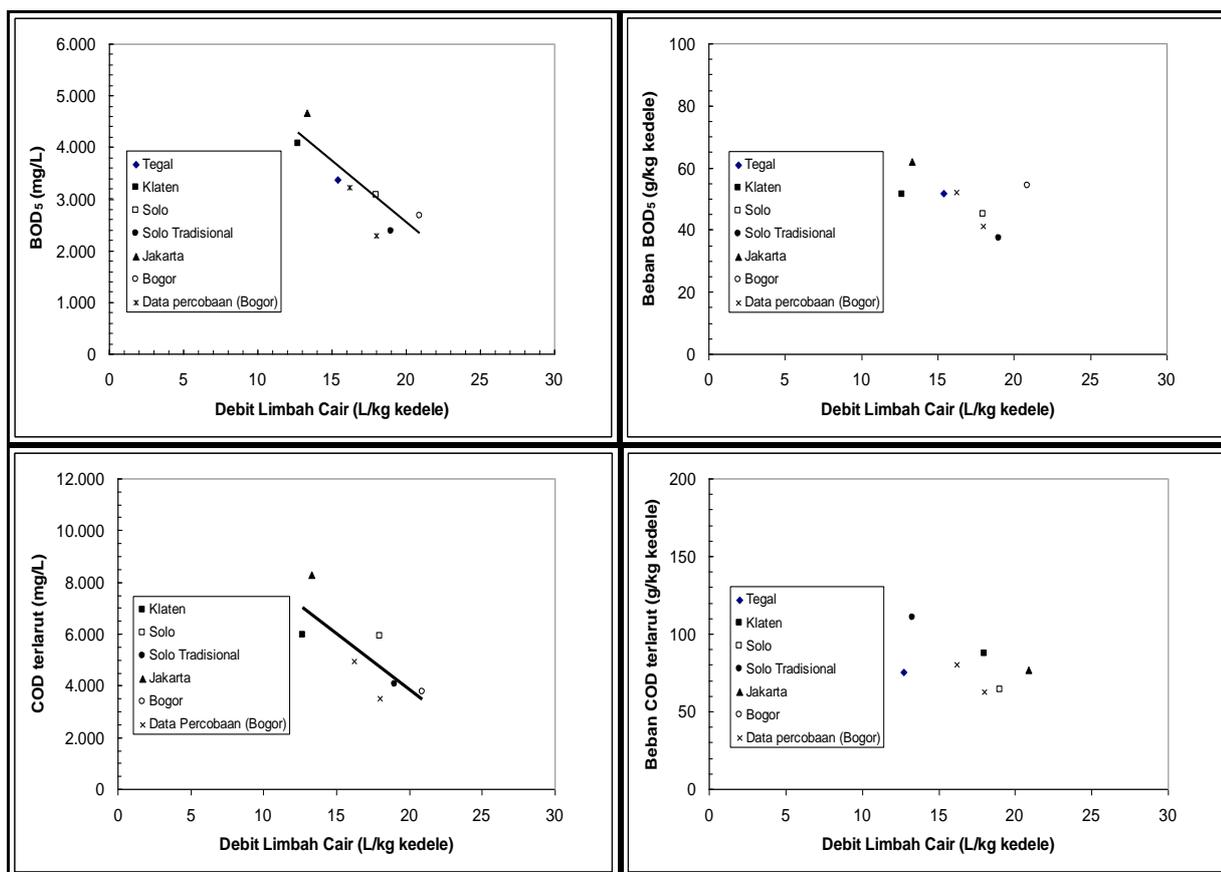
**Gambar 6.** Pengaruh Debit Limbah Cair Pada Konsentrasi dan Beban BOD<sub>5</sub> Limbah Cair Industri Tahu
