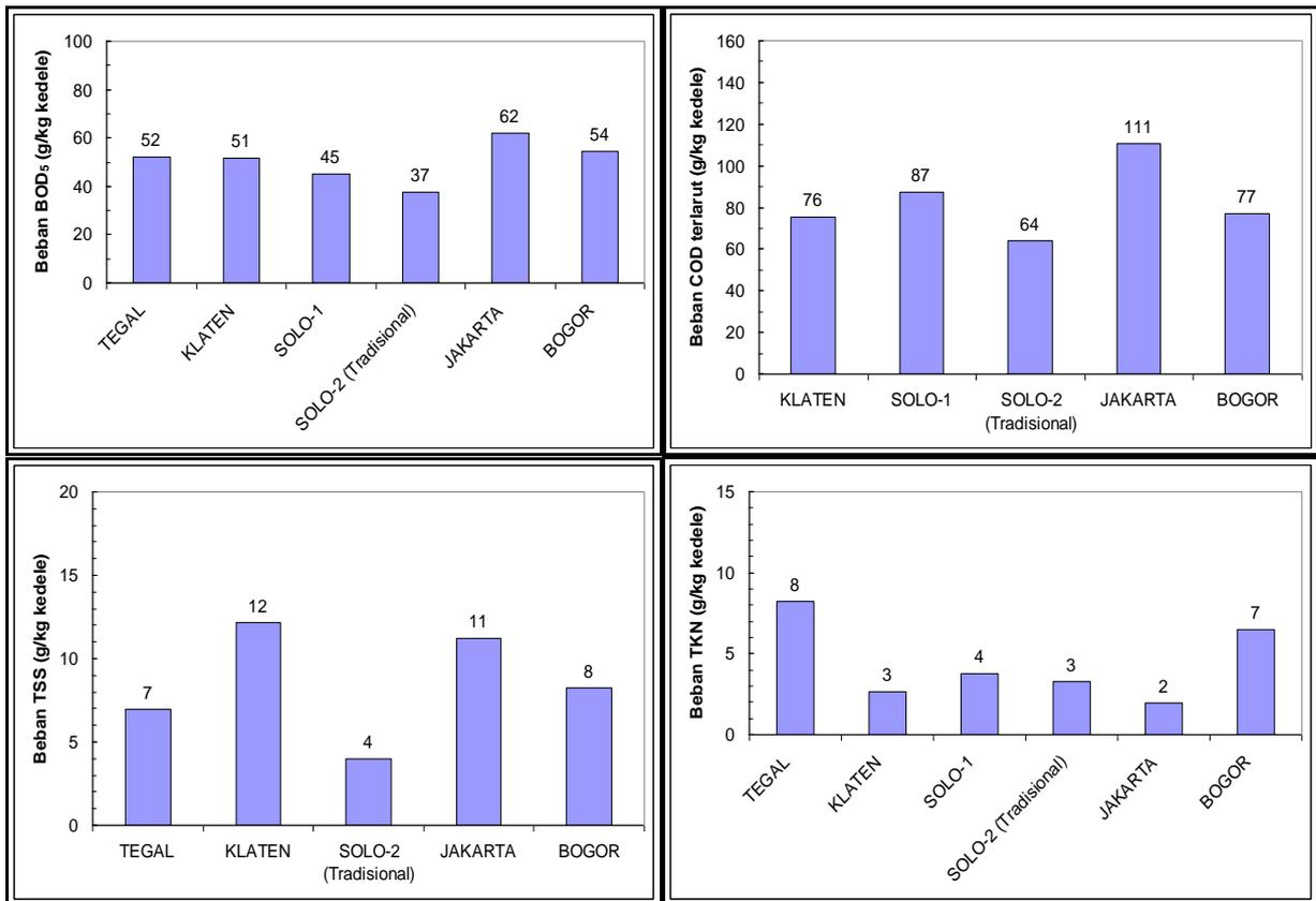
Gambar 4. Beban Polutan dalam Limbah Cair Industri Tahu di Berbagai Daerah yang Disurvei
