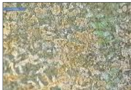
Gambar 10. Struktur Mikro Baja Rel Kereta Api Setelah Pengujian Korosi Pada Lumpur Sawah
