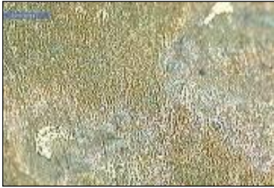
Gambar 22. Struktur Mikro Baja Pipa Minyak dan Gas Setelah Pengujian Korosi Pada Lumpur Sawah
