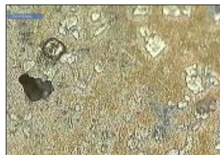
Gambar 18. Struktur Mikro Baja Tiang Listrik Setelah Pengujian Korosi Pada Lumpur Sawah
