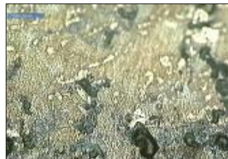
Gambar 17. Struktur Mikro Baja Tiang Listrik Setelah Pengujian Korosi Pada Lumpur Lapindo
