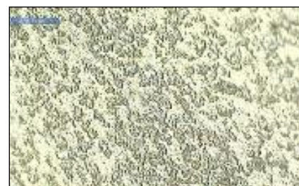
Gambar 20. Struktur Mikro Baja Pipa Migas Sebelum Pengujian Korosi
